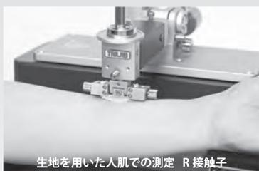
生地を用いた人肌での測定 R 接触子
