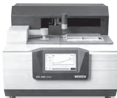
示差走査熱量測定装置 DSC 300 Caliris® Supreme & Select/Classic
